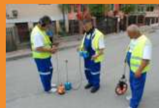
Tehnologii utilizate pentru prelocalizarea pierderilor de apă : teledetectia, georadarul, debitmetrie, loggeri de zgomot.
