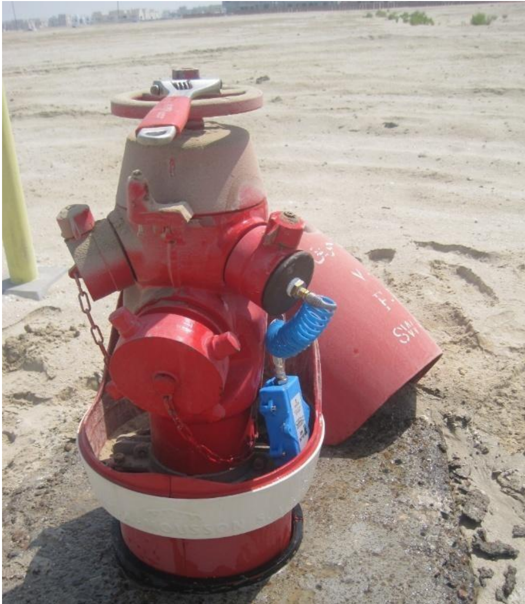
Înregistrarea temporară a presiunii în interiorul unui DMA în Emiratele Arabe Unite
